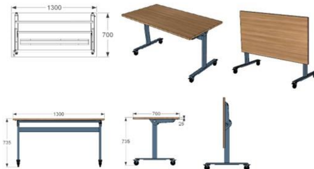
Figura 28 - Planta baixa, vista frontal, vista lateral (aberto e fechado) e perspectiva (aberto e fechado) modelo item 26
